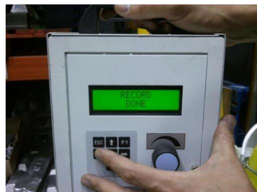
**Figure 4.9.** Saving parameter using the left arrow
