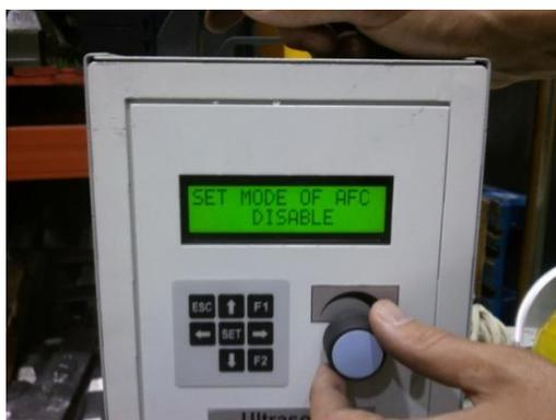
**Figure 4.8.** Thumbwheel to change parameter values
